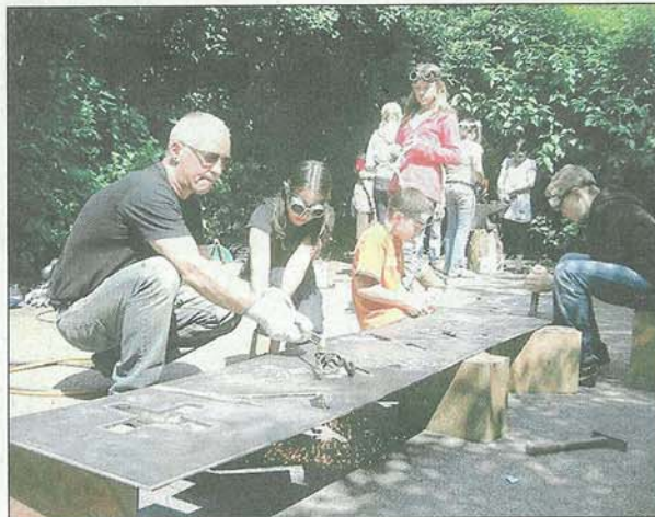
■ Künstler bei der Arbeit: Gregor Merten zeigt den Kindern, wie sie aus der Stahlplatte Formeln und Zahlen mit Hilfe des Schneidbrenners heraus trennen. Foto: Knops-Feiler
